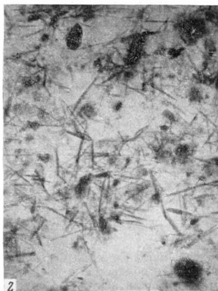
Фиг. 95. Электронномикроскопические снимки палыгорскита и сепиолита в глинистых отложениях палеогена Ферганы, фракция <0,001 мм, увел. 10 000.
