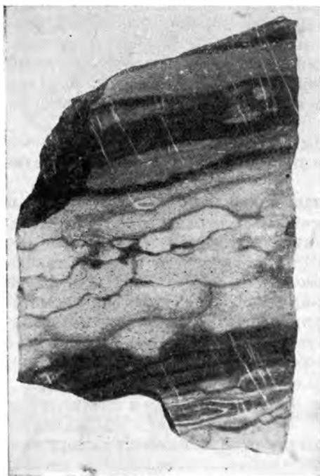
Рис. 18. Чередование карбонатных и железистых прослоев в рудной пачке. В светлом карбонатном прослое видна петельчатая текстура. Рудный прослой состоит из чередования гематита и яшмы. Нат. вел.
