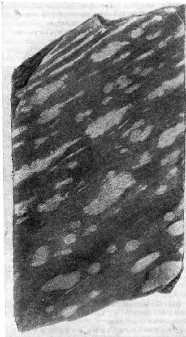
Рис. 15. Органогенно-обломочный известняк с примесью туфогенного материала, с конкреционными прослоями и линзами (тип 76). Нат. вел.
