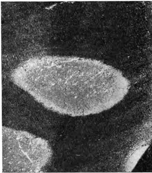
Рис. 5. Тонкослоистая кремнисто-карбонатная порода с хорошо оформленными конкрециями (тип 2б). Шлиф,  $\times 5$ . Видно зональное строение конкреции и след слоя, по которому она образовалась
