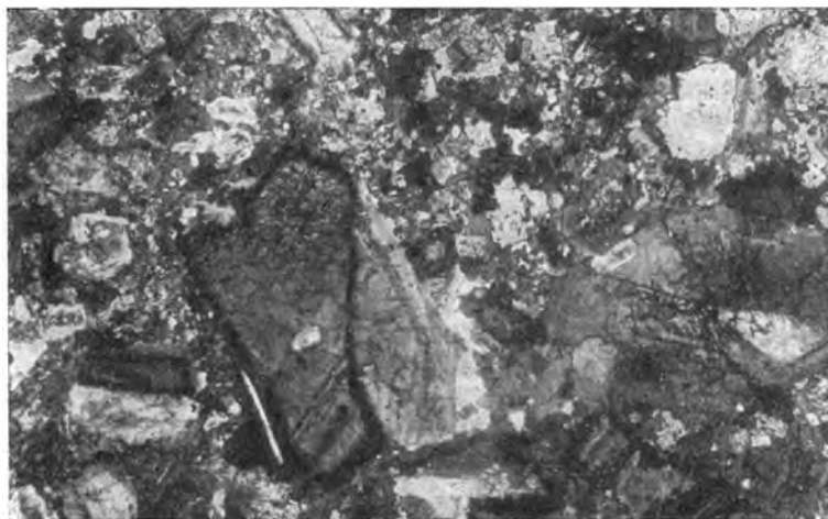
Фиг. 51. Граносиенит-порфит с вкрапленниками зонального плагиоклаза, обрастающими калинатовым полевым шпатом. Мелкозернистая основная масса содержит кварц. Ув. 20, ник. +
