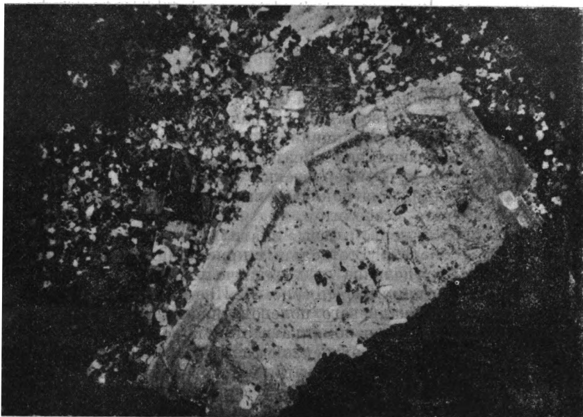
Рис. 5. Зерно плагиоклаза с включениями темноцветных минералов. \times 25 ; нпк. +.
