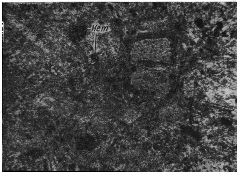
Рис. 4. Очень тонкая редкая окрапленность гематита по магнетиту в флюидальном андезитовом порфирите (D 3fr ). Порода имеет нормальную полярность. Шл. 28—8. × 120; ник. ||.
