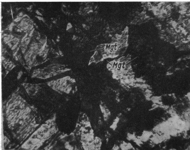
Рис. 5. Разложенный магнетит в катаклазированном андезито- базальтовом порфирите ( T_{1-2} ) с обратной полярностью. Шл. 9—9, \times 120 ; ник. \parallel .
