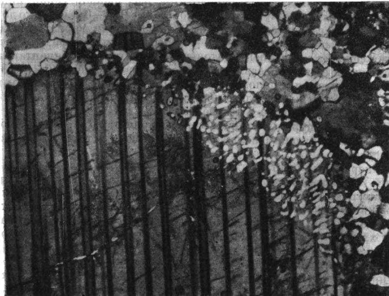
Рис. 3. Кислые пегматиты с гиперстеном. Каплевидные новообразования кварца в андезине в контакте с гранофиром. \times 50 ; ник. + .
