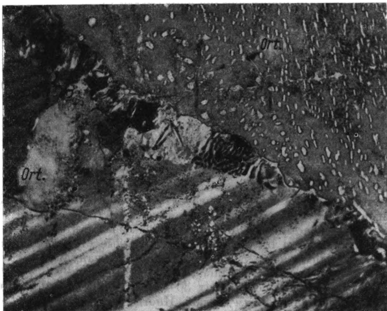
Рис. 2. Кислые пегматиты с гиперстеном. Появление микрпертитов на контакте андезина с микропертитовым ортоклазом. В левой части снимка виден отторжевец ортоклаза в андезине. \times 110 ; ннк. +.
