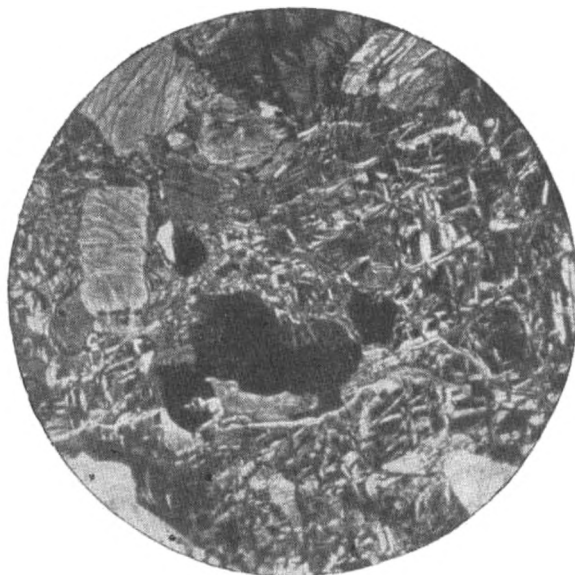
Рис. 6. Апогарцбургитовый серпентинит петельчатой структуры. Видны образования бастита и крупное зерно хромшпинелида (черное). Толпакский массив. Николи +, увел. 20
