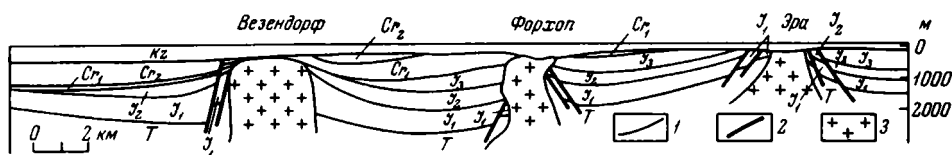
Рис. 1. Субширотный геологический профиль через Гифхорнскую структурную зону (по E.Brand, R. Hoffman, 1963)
