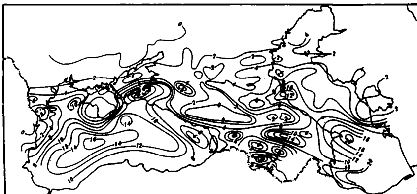
Рис. 5. Схема глубин поверхности "гранитного" слоя, км
