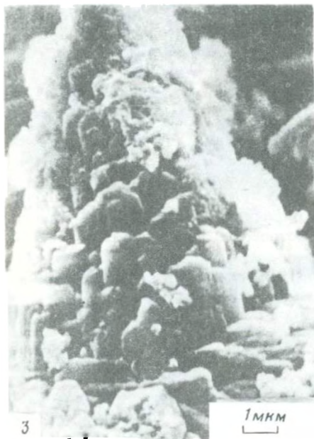
Рис. 2. Микрофотографии продукта, полученного в результате поглощения растворенных форм Ni, Co, Fe, Mn из морской воды гаусманитом, снятые под сканирующим электронным микроскопом
