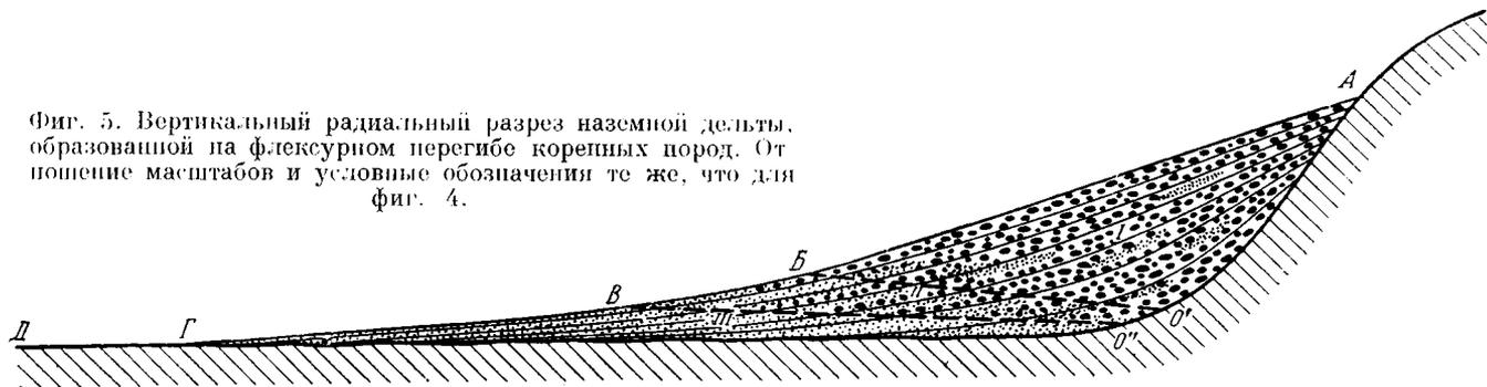
Фиг. 5. Вертикальный радиальный разрез наземной дельты, образованной на флексурном перегибе коренных пород. Отношение масштабов и условные обозначения те же, что для фиг. 4.
