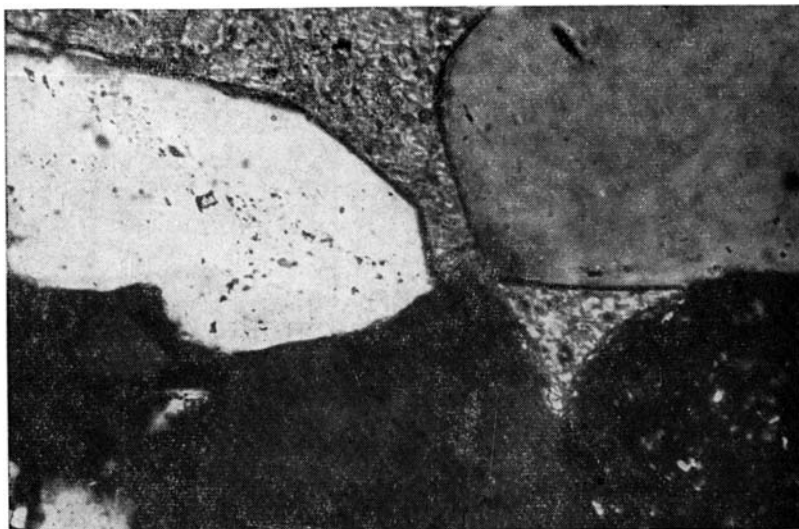
Фиг. 7. Появление идиоморфной огранки аутигенного кварца в песчанике с перекристаллизованным карбонатным цементом. Ув. 30
