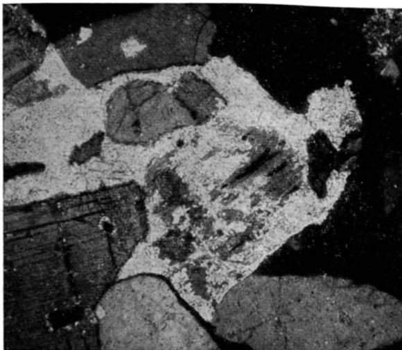
Фиг. 3. Коррозия плагиоклаза кальцитом. Ув. 50
