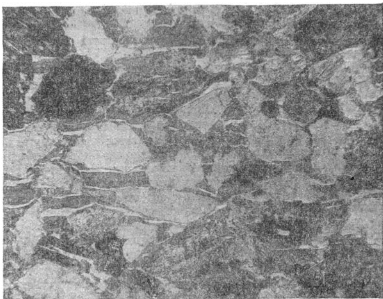
Рис. 4. Новообразования глинистого вещества в песках. Яркополяризующие каемки вокруг обломочных зерен Ув. 45, ник. +
