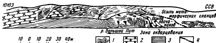
Рис. 45. Контакт рифейских метаморфических образований и кембрийских отложений (правобережье р.Большого Пита напротив о-ва Пема)
