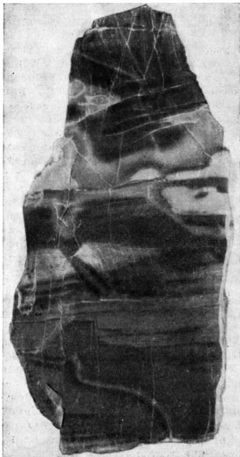
Фиг. 15. Яшма. Видны следы перекристаллизации вблизи трещин и исчезновение тонкой слоистости
