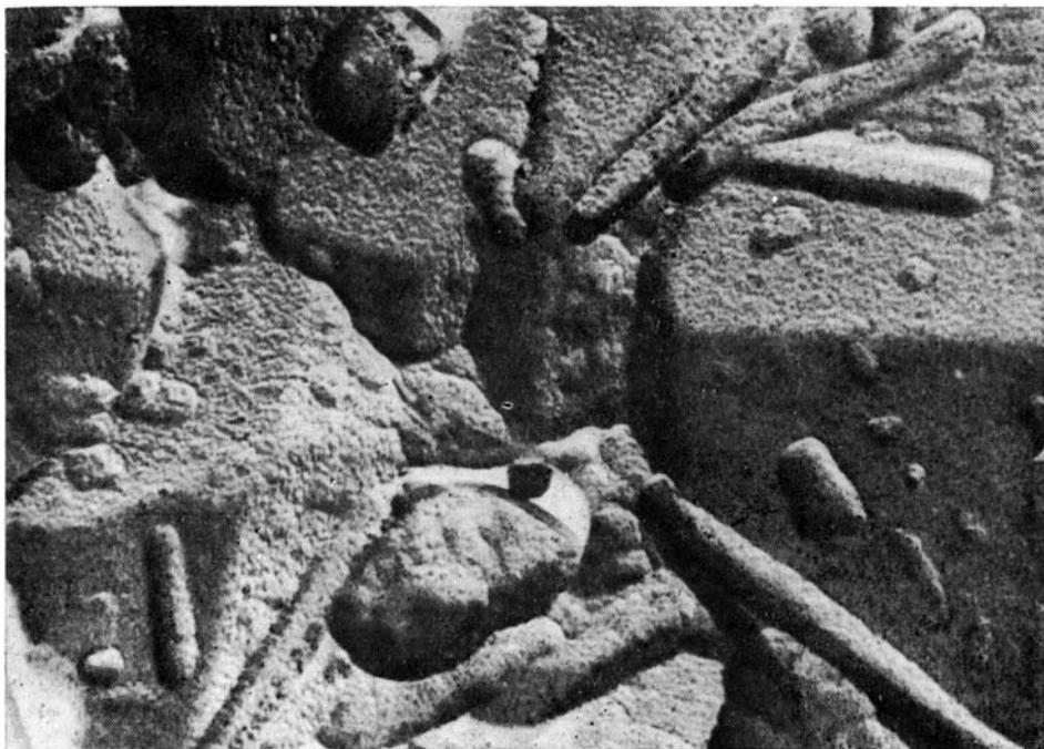
Фиг. 14. Фтанитоид. На кристаллах видны палочковидные частицы и глобулиты
