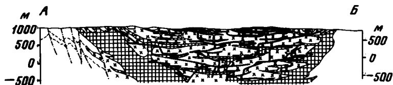
Рис. 68. Геологическая схема и разрез Сарышокинского гранитоидного массива (по данным А.Г. Денисюка, В.Н. Киньшакова, Н.А. Клепикова, В.З. Ячкова, с небольшими изменениями)
