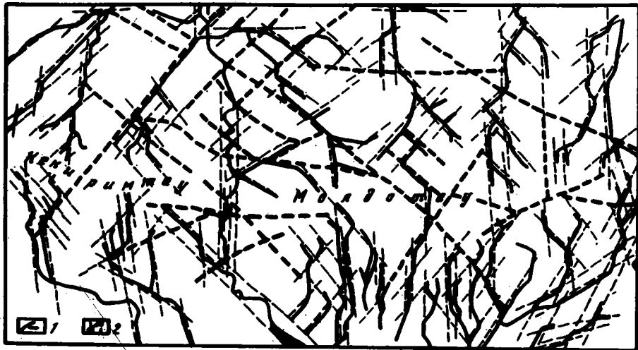
Рис. 25. Система трещин и разрывов хребтов Кекиримтау и Молдотау в районе ущелья р. Нарын 1 - эрозионные ложбины; 2 - разрывы и трещины разных порядков
