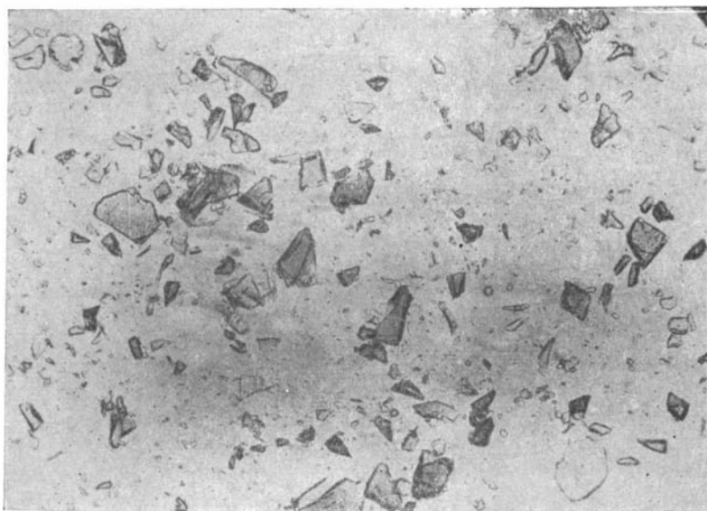
Фиг. 20. Микроскопический снимок осадка 5, полученного при \text{pH} = 7,90 и E_{\text{н}} = +440 мв. Увел. 150. При одном никеле. Система \text{FeCl}_3 - \text{Na}_2\text{SiO}_3 - \text{NaOH} - \text{H}_2\text{O}
