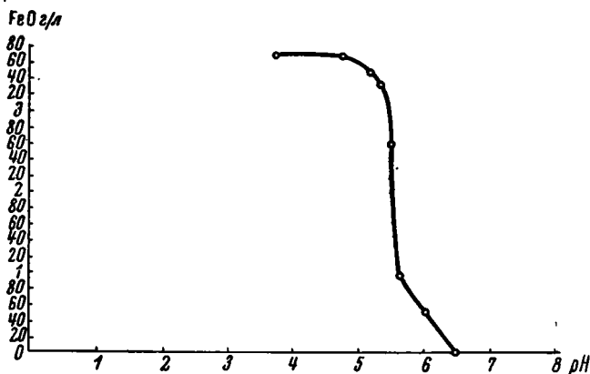
Фиг. 7. Осаждение \text{Fe}^{2+} из раствора \text{FeSO}_4 в зависимости от pH среды
