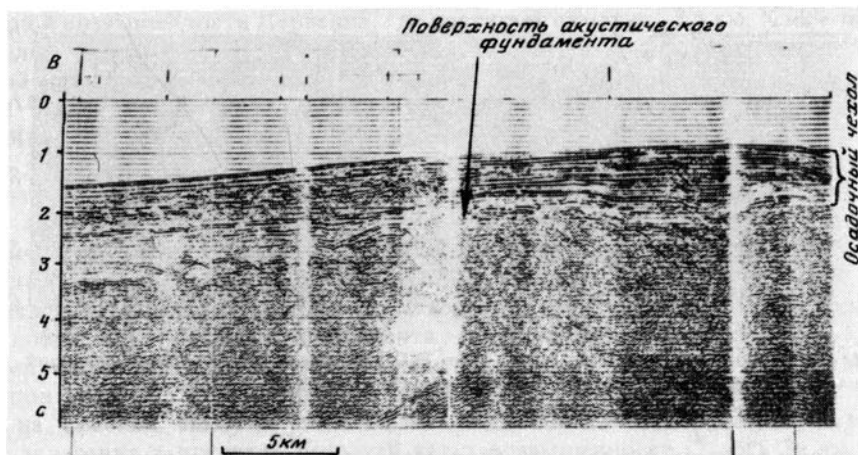
Рис. 12. Фрагмент временного сейсмического разреза (по Г.Ф. Балабко и др.), показывающий соотношение нижних слоев осадочного чехла и поверхности акустического фундамента в южной части Татарского пролива
