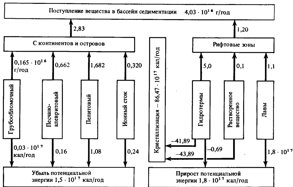
Рис. 23. Схема количественной оценки вещества, поступающего в океаны, и трансформации потенциальной энергии
