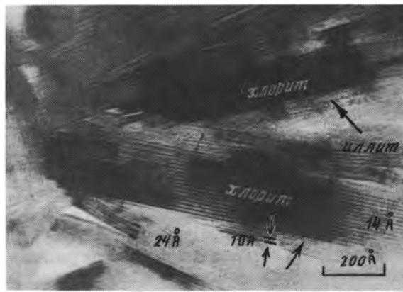
Рис. 39. Прорастающие кристаллы иллита и хлорита в цементе ломонитовых туфогенных пород Новой Зеландии [Ahn et al., 1988]
