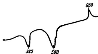
Фиг. 5. Термограмма породы из гиббситово-каолининовой зоны коры выветривания диабазовых порфиритов (образец не отмечен)
