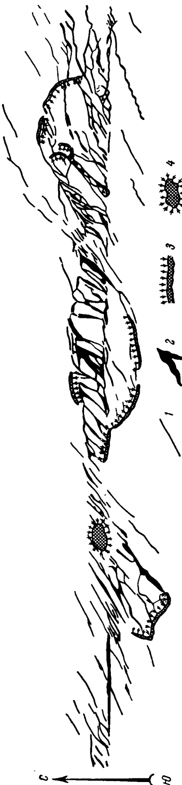
Фиг. 15. Строение сбросо-сдвига у северного подножья горы Ихэ Богдо между ущельями Билути и Арбаргос.
