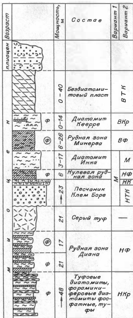
Рис. 45. Разрез фосфоритоносных отложений пустыни Сечура, Перу (по /75/).
