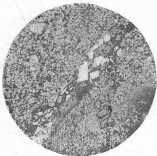
Фиг. 3. Пржилок кварца с теннантитом в пиритовой руде. Месторождение Бакр-Узяк; шлиф 186. \times 40 .
