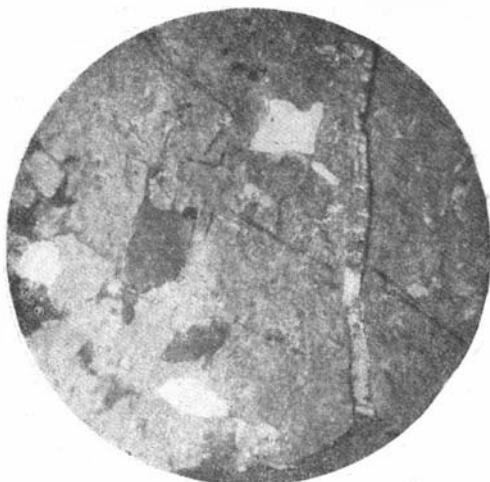
Фиг. 14. Залечивание трещин в раздробленном граните альбитом. Обр. 347. Николи \perp . \times 25 .
