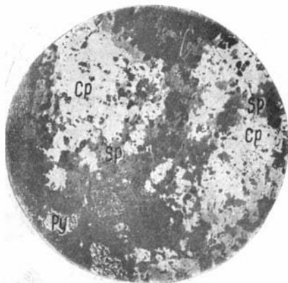
Фиг. 16. Выделения пирита и сфалерита в халькопирите. Месторождение Юлалы; шлиф 35. \times 40 .
