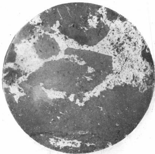
Фиг. 17. Коррозия жильного минерала пирротином. Месторождение Южный Урал; шлиф 241. \times 40 .
