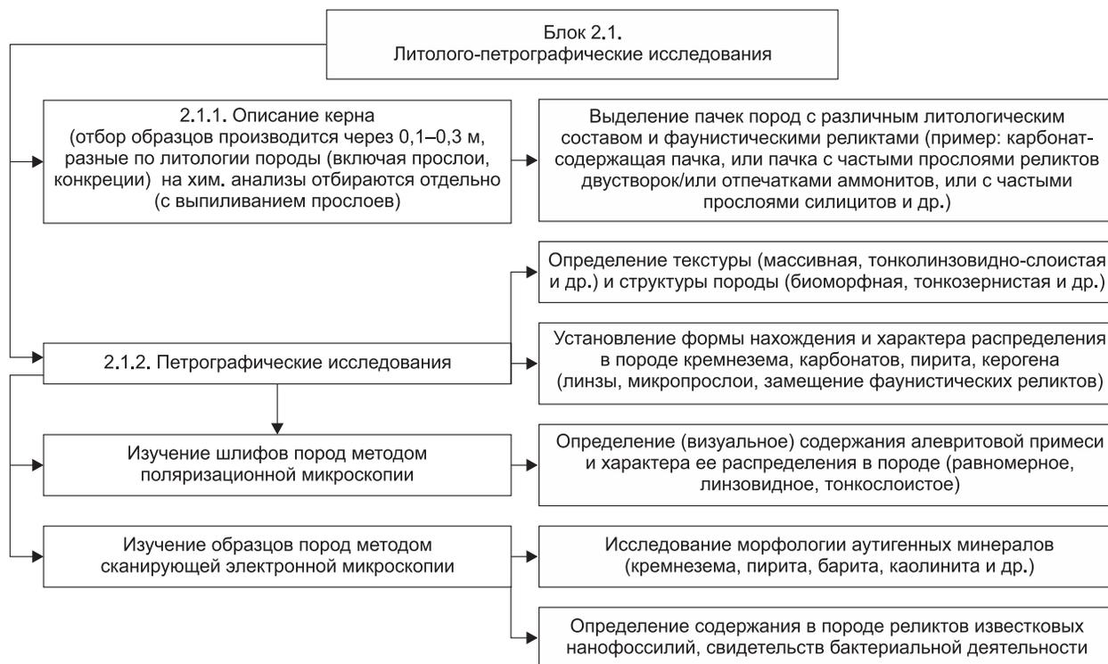
Рис. 2.1.1. Схема литолого-петрографических исследований баженовской свиты.
