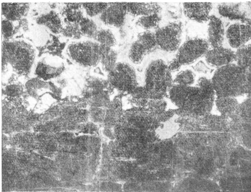
Рис. 12. Рифейский фосфорит с р. Хорё (Восточный Саян, северное продолжение Ухагольского месторождения Хубсугульского бассейна). Николи Х. Темное — фосфат, светлое — карбонат. Виден переход от сплошного слоистого фосфорита к пеллетному вследствие карбонатизации. Увел. 70 (образец П. В. Осокина).
