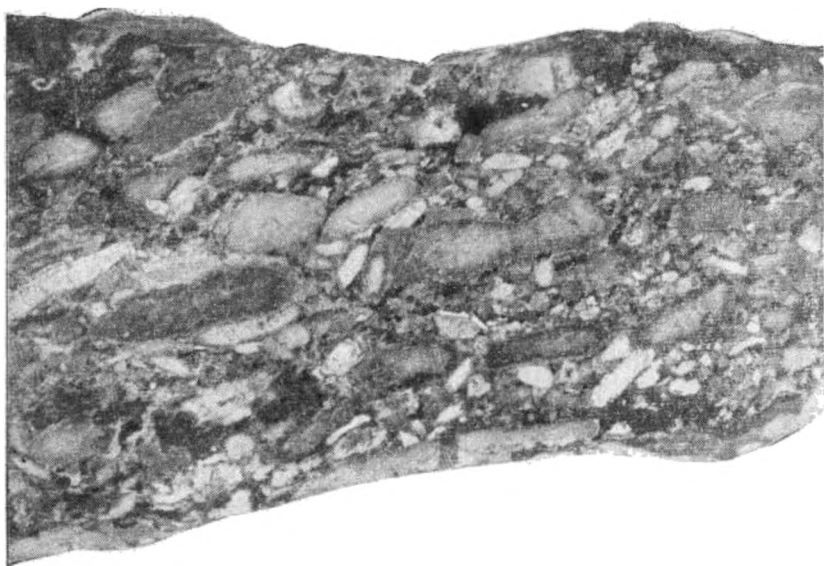
Рис. 5. Рифейский фосфоритовый «гравелит» с горы Кучестаиха (Боградское фосфатопоявление, Красноярский край). «Галька» сложена сплошным, слегка окварцованным фосфатом, различно окрашенным. Цемент кальцитовый. Внешне порода типично кластогенная. Увел. 2 (образец Г. Н. Бровка).
