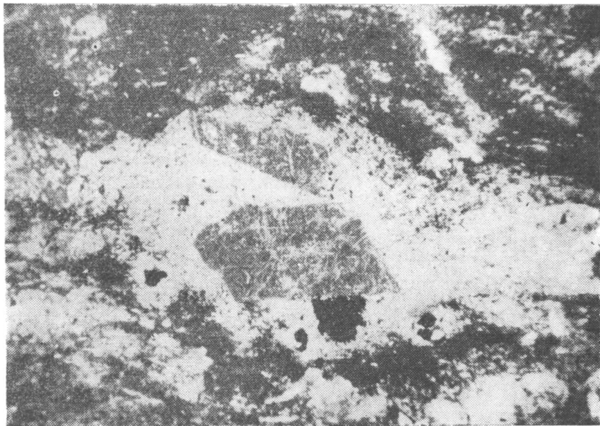
Рис. IV—22 Литонидный игниспумит еккульского типа. Деталь строения фьямме, Ув. 60, при одном никеле.
