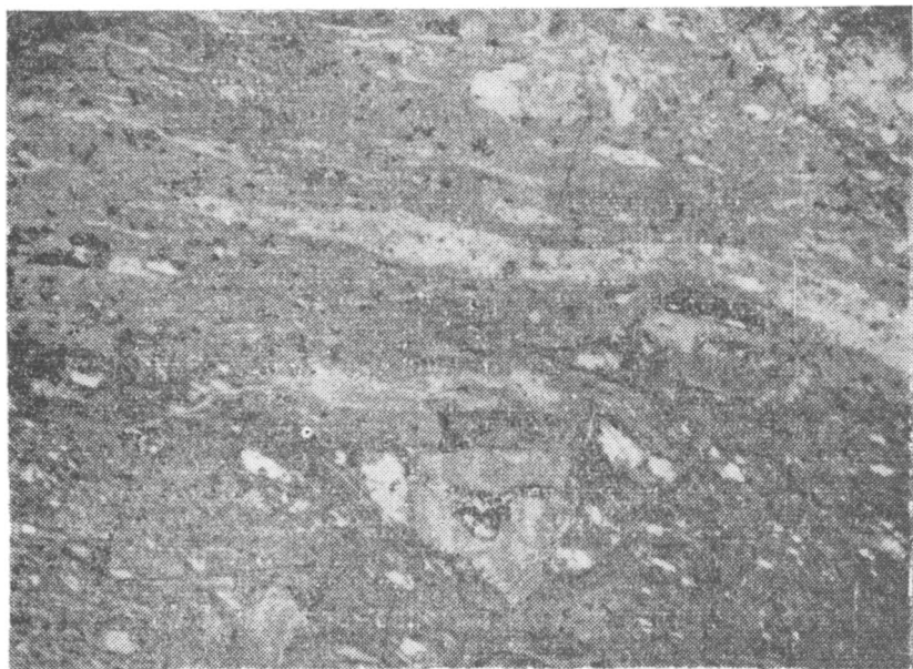
Рис. IV—9. Игниспумит айнабулакского типа, слагающий оболочку шара. Светлые полосы — шлировые обособления, состоят из кварц-полевошпатового вещества. Ув. 22, при одном никеле.
