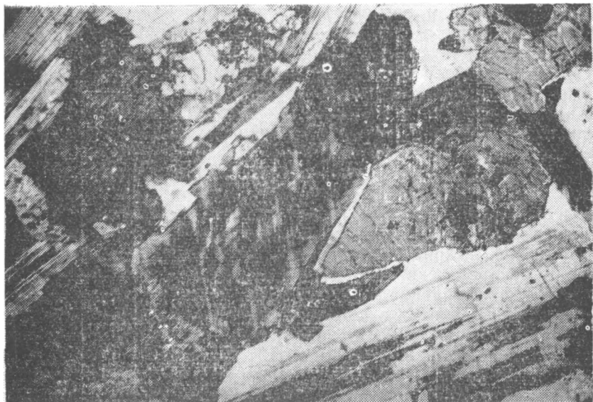
Рис. IV—43. Габбро-норит с габбро-офитовой структурой. Ув. 22, при скрещенных николях.
