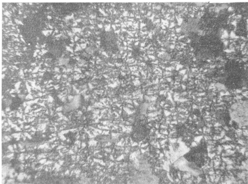
Рис. VI—4. Кварцево-турмалиновый вторичный кварцит. Ув. 110, при скрещенных никелях.
