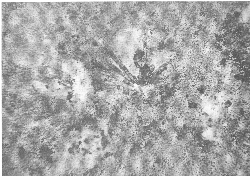
Рис. VI—3. Кварцево-серицитовый вторичный кварцит. В центре кристаллы турмалина. Ув. 110, при одном никеле.
