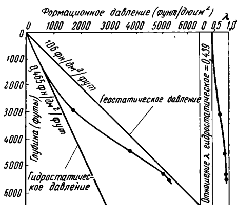
Рис. 7. Изменение с глубиной давления поровых вод и соответствующих значений \lambda в Кхаурфилд (Пакистан) (Керр and Ward, 1934)
