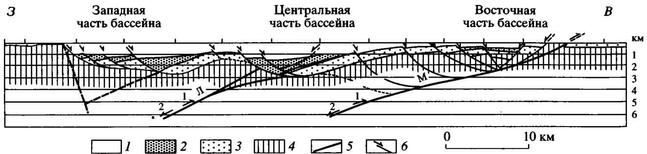
Рис. 5. Разрез через впадину Альбукерк в южной части рифта Рио-Гранде, вдоль линии сейсмического профиля DECORP приблизительно на широте 34^{\circ}30' с.ш., по [39].
