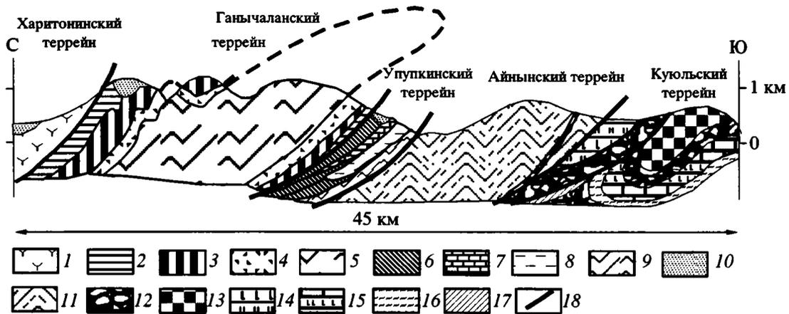
Рис. 3. Сводный геологический профиль (линия профиля показана на рис. 1)
