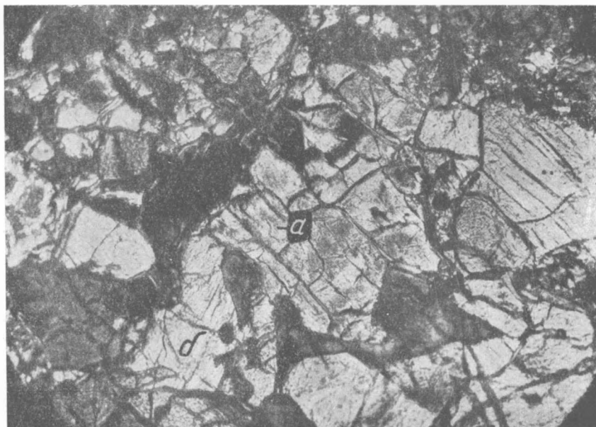
Ф и г. 10. Лердолит. Включение хромшпинелида (а) в моноклиный пироксен (б). Увеличение \times 45 , никели скрещены. Образец 363. Кемпирсайский массив.
