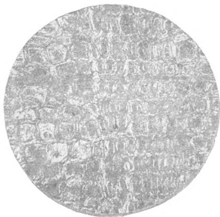
Фиг. 1. Ново-Карантинный рудник. Псевдоморфоза барита по древесине, поперечный срез. Видны клетки различной толщины, соответствующие различным периодам роста. Снято при скрещенных николях.  $\times 50$ .
