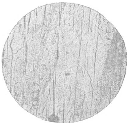
Фиг. 7. Кыз-аульский рудник. Псевдоморфоза фосфата по дереву, продольный срез. Видны волокна и сердцевинные лучи. Снято при одном николе.  $\times 50$ .
