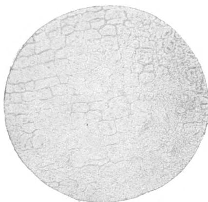
Фиг. 8. Кыз-аульский рудник. Псевдоморфоза барита и фосфата по древесине, поперечный срез. Участки с клеточным строением — фосфат, остальное — барит. Снято при одном николе.  $\times 120$ .
