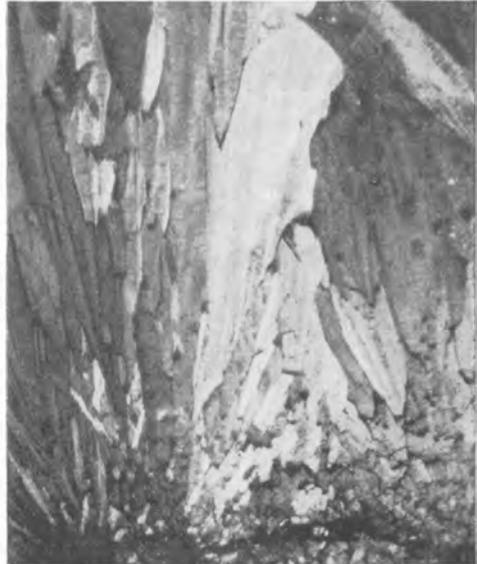
Фото 17. Радиально-лучистое строение прожилка пирролизита под микроскопом. Полированный шлиф. Николи +. Увел. 77.
