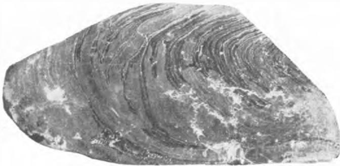
Фото 24. Стяжение пиролюзита и гётита (темносерое). Черные концентры представлены опалом. Пришлифованная поверхность. Натур. вел.
