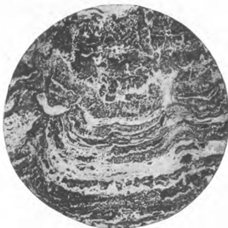
Фото 9. Колломорфное строение пиролизитовой конкреции. Полированный шлиф. Увел. 6.
