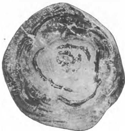
Фото 8. Строение пиролизитовой конкреции. Пришлифованный срез. Натур. вел.
