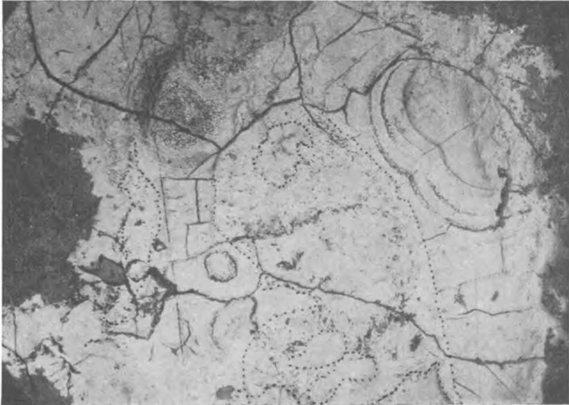
Фото 34. Вернадит (с трещинками усыхания), частично замещенный рансьейтом (окопчено точками). Справа в верхней части снимка видна почка вернадита, наружные концентры которой сложены рансьейтом. Черное — опал. Полированный шлиф. Николи || . Увел. 48.
