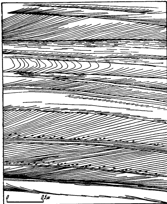
Фиг. 77. Пункт № 1, слой 1. Русловые отложения; отмечается разделение косослоистых серий сериями горизонтальнослоистыми.
