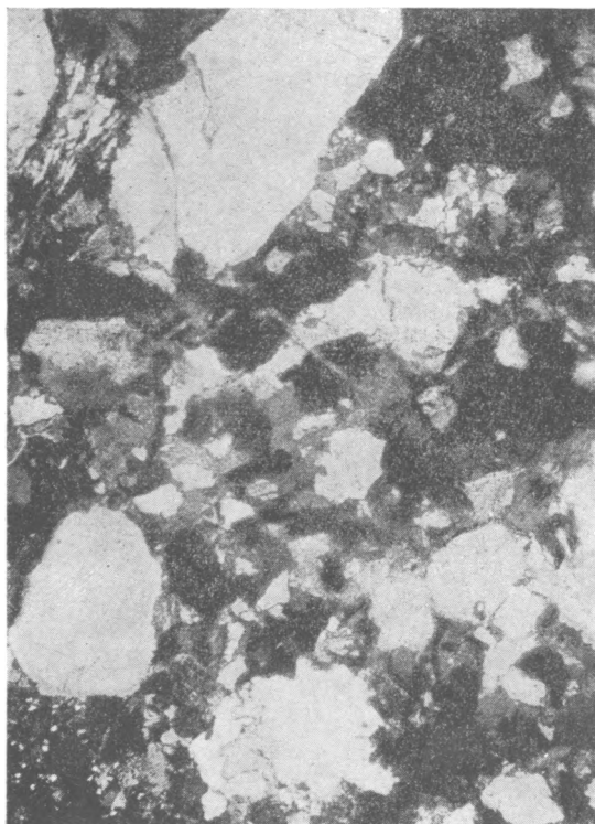
Фиг. 30. Кварцевый разномерный русловой песчаник над известняком K_0 ; Успенский район. Видна плохая сортировка обломочного материала, представленного зернами кварца, кремня и кварцитов. Увел. 20.
