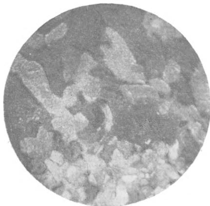
Рис. 8. Фосфат кальция, частично слабо раскристаллизованный в сферолиты, цементирует зерна и кристаллы сидерита. Николь+,  $\times 40$ .
