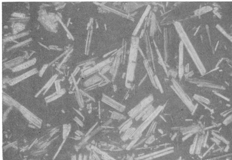
Рис. 3. Микрофотография осадка несквегонита  $MgCO_3 \cdot 3H_2O$ . Опыт № 1. Увел. 40. Николи скрещены.
