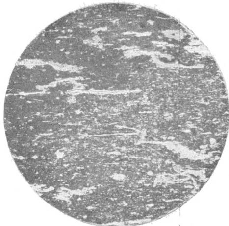
2. Горючий сланец, р. Ташкыскан. Плотная разность.  $\times 40$ . Видна своеобразная мелкоплойчатая структура породы.
