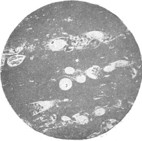
1. Кремнь, р. Баса.  $\times 40$ . Разрезы многочисленных птеропод и остракод на фоне сильно окремненной основной массы.
