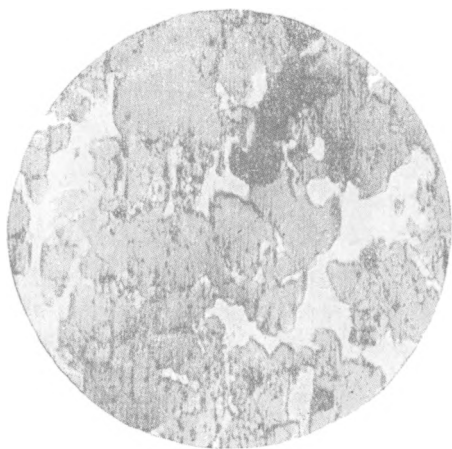
Фиг. 12. Иджеван, месторождение № 10. Замещение сфалерита галенитом и халькопиритом (нитевидная структура). \times 30
