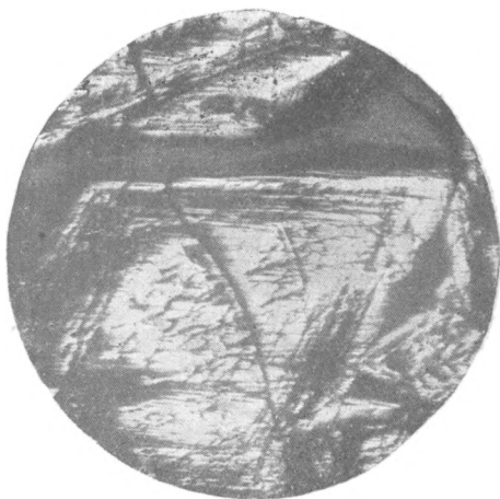
Фиг. 4. Н. Дашкесан, участок Тер-Нерсесова. Зона́рная структура кристаллов донанита. \times 30
