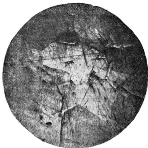
Фиг. 3. Структура галенита, выявленная травлением \text{HBr} . \times 80 .
