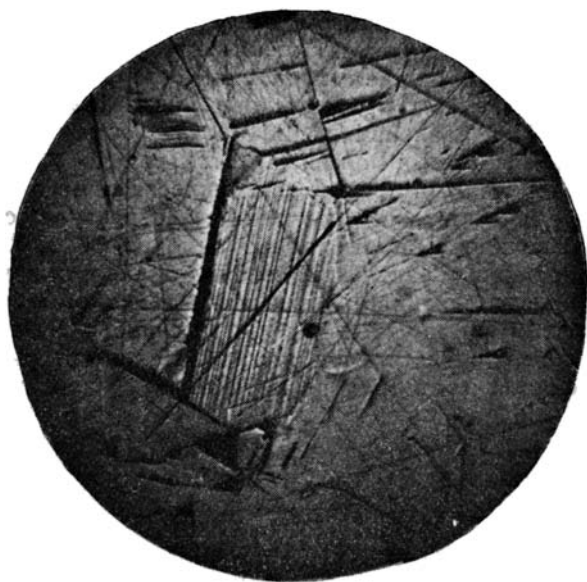
Фиг. 5. Линии трансляции в галените, вызванные давлением. \times 80 .
