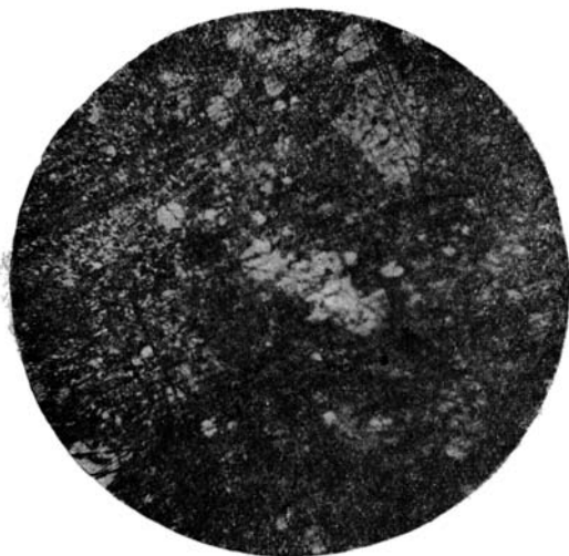
Фиг. 13. Структура сернистого железа, полученная под влиянием давления до 25 000 атм. \times 80 .
