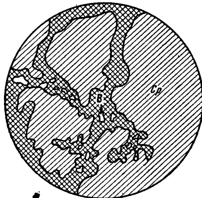
Рис. 3. Шлиф 410. \times 50 . Пржилки бурнонита в халькопирите. Остаточные островки бурнонита окружены вторичными, окисленными минералами 1 — бурнонит В; 2 — халькопирит (Ср); 3 — нерудный минерал
