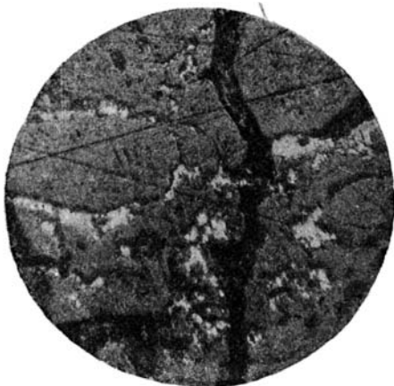
Рис. 2. Шлиф 521a Прожилки галенита (белый) в кварце (темносерый). \times 20
