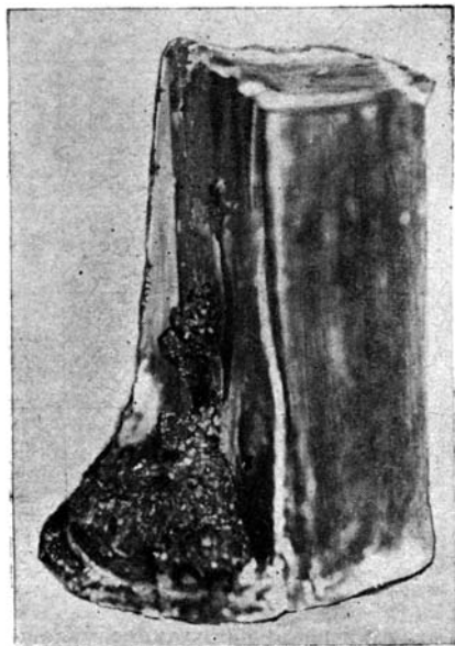
Фиг. 18. Промороженный снизу цилиндр. У нижнего и среднего окошечек перегородки смерзшаяся часть фракции крупного песка диаметром 2—1 мм. Смерзание фракции крупного песка 2—1 мм произошло вследствие миграции жидкой воды из фракции диаметром 0.5—0.15 мм, расположенной за перегородкой
