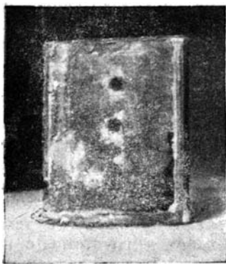
Фиг. 8. Промороженный сверху цилиндр. У нижнего окошечка перегородки смерзшаяся часть фракции крупного песка диаметром 2—1 мм. Смерзание фракции 2—1 мм произошло вследствие миграции в нее жидкой воды из фракции диаметром 1—0.5 мм, расположенной за перегородкой
