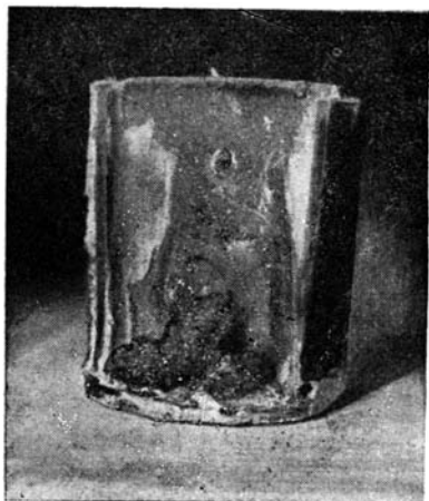
Фиг. 17. Промороженный снизу цилиндр. У нижнего окошечка часть смерзшейся фракции крупного песка диаметром 2—1 мм. Смерзание фракции крупного песка 2—1 мм произошло вследствие миграции в нее жидкой воды из фракции диаметром 1—0.5 мм, расположенной за перегородкой
