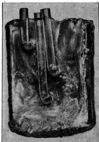
Фиг. 23. Промороженный сверху цилиндр. Черта на трубке, вделанной в нижнее окошечко перегородки, отмечает объем содержащейся в трубке воды. Вода мигрировала в трубку из фракции диаметром 0.5—0.15 мм, расположенной за перегородкой
