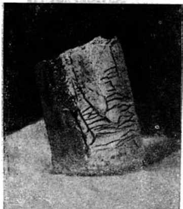
Фиг. 2. Цилиндр с мерзлым грунтом, половина песка и половина глины № 4. Много выделившегося льда в глине, но не в песке.
