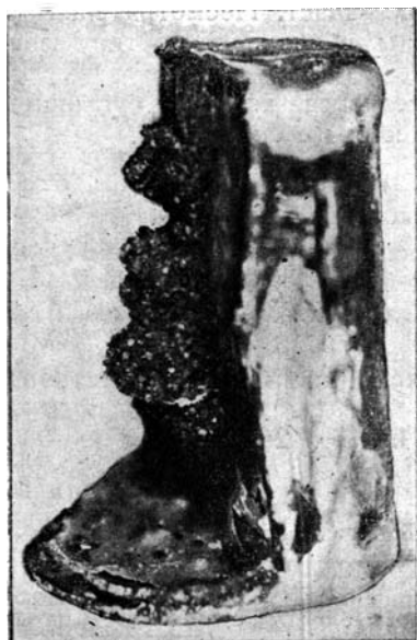
Фиг. 19. Промороженный снизу цилиндр. У всех трех окошечек перегородки смерзающаяся часть фракции крупного песка диаметром 2—1 мм. Смерзание фракции крупного песка произошло вследствие миграции жидкой воды из фракции диаметром 0.25—0.05 мм, расположенной за перегородкой
