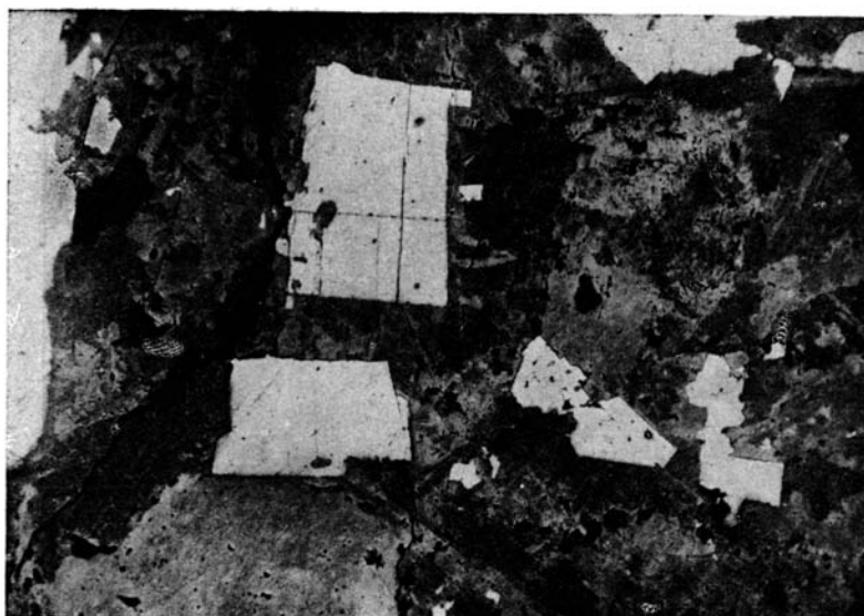
Фиг. 13. Тоже. Снято после травления сфалерита в парах царской водки
