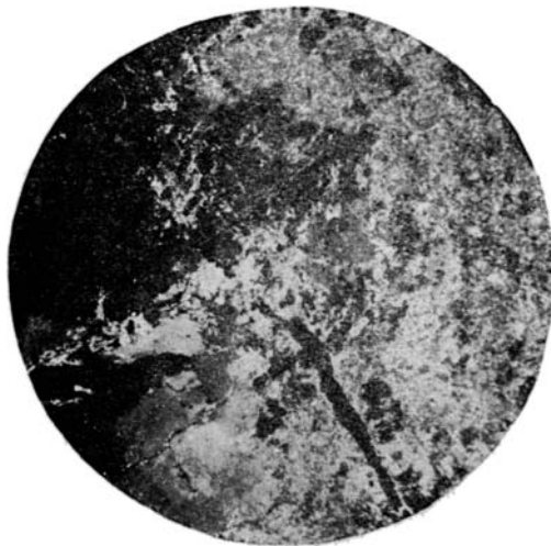
Фиг. 3. Кварц из золотоносной жилы Пологой, пересечен по двум взаимно-перпендикулярным системам трещин отдельности слюдяно-флюоритовыми прожилками. Шлиф 139 \times 16 . Николи +
