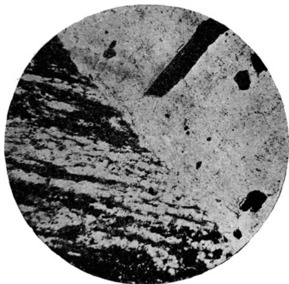
Фиг. 7. Прожилок из штокверка № 1. Длиннопризматические кристаллы кварца и арсенопирита, ориентированные перпендикулярно стенкам трещины. Шлиф 114×42. Николи ||
