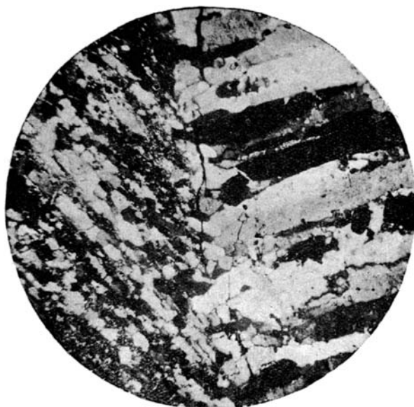
Фиг. 6. Прожилок из штокверка № 1. Длиннопризматические кристаллы кварца и арсенопирита, ориентированные перпендикулярно стенкам трещины. Шлиф 114×42. Николи +
