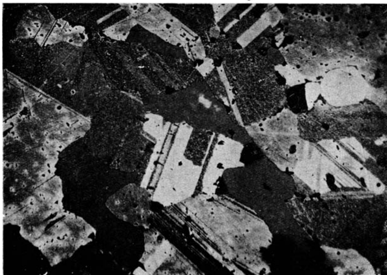
Фиг. 8. Результат травления сфалеритового агрегата в парах царской водки. Гладкие непротравившиеся серые зерна — кварц. Хорошо видно полисинтетическое двойниковое строение зерен сфалерита. Месторождение Левиха II. По Т. Н. Шадлун. \times 95
