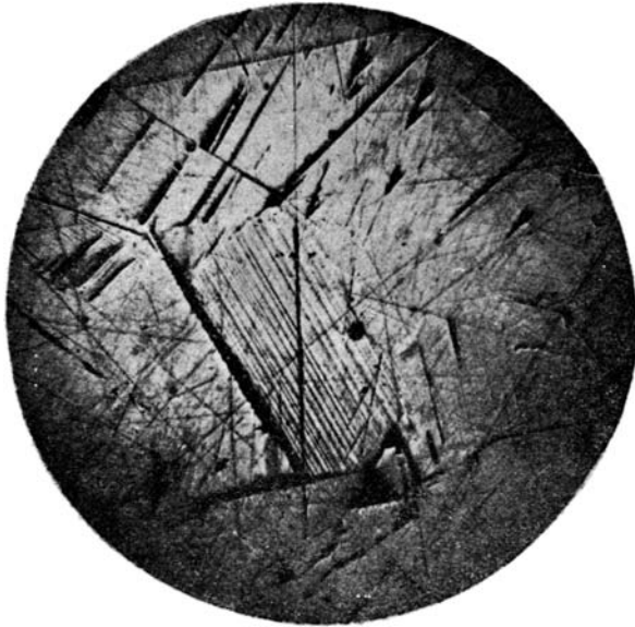
Фиг. 1. Линии скольжения в галените, полученные в результате одностороннего давления в 500 атмосфер на прессе. Ув. 60
