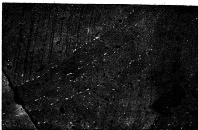
Фиг. 4. Пластинчатые двойники в сфалерите и выделения халькопирита (белое) по двойниковым швам. Есауловское месторождение (Донбасс). Ув. 60
