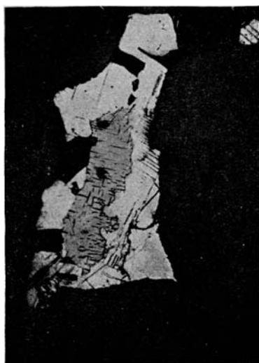
Фиг. 4. То же зерно после вторичной доводки и полировки, протравленное в парах смеси \text{HCl} + \text{CrO}_3 (50% раствор). Среди никелистой платины, занимающей периферическую часть, отчетливо выявились легкопротравляющиеся в виде черных пятен зерна какой-то другой разновидности платины (повидимому, медистой).
