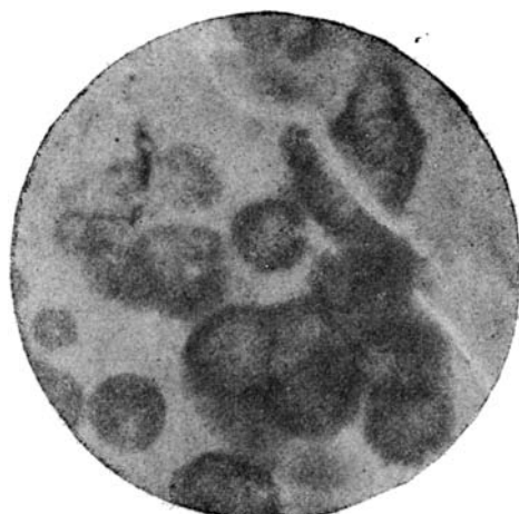
Фиг. 2. Сферолиты магнетита в шамоте. Увелич. \times 760
