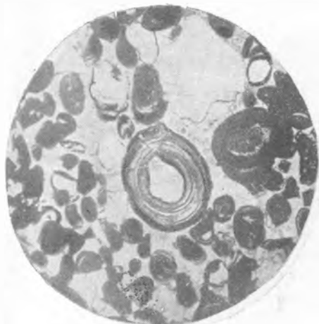
Фиг. 133. Руда пласта «Магнитный кварцит». В центре — крупный концентрический слоистый магнетито-шамозитовый оолит, кварцевое ядро которого частично замещено кальцитом. \times 60 (по П. Вагнеру).
