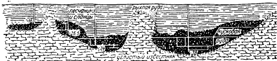
Фиг. 85. Формы и условия залегания железо-марганцевых руд в карстовых воронках на девонских массивных известняках Рейнских сланцевых гор (по Эйнеке и Келеру).
