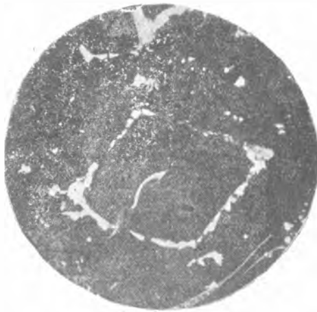
Фиг. 142. Перекристаллизованная руда г. Даспурт из Syfertfortain № 963 Rustenburg District. Кристаллы магнетита, окруженные серицитом в цементе из железной слюдки. \times 50 (по П. Вагнеру).
