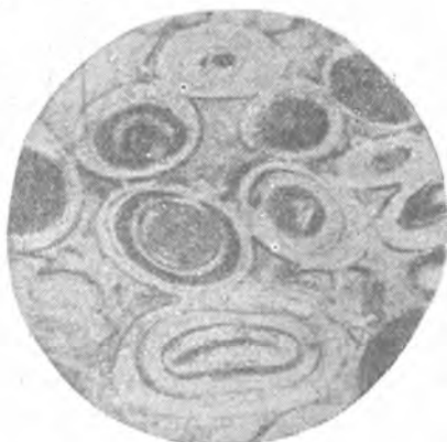
Фиг. 97. Микроструктура оолитовых гидрогессито-шамозито-сидеритовых руд.
