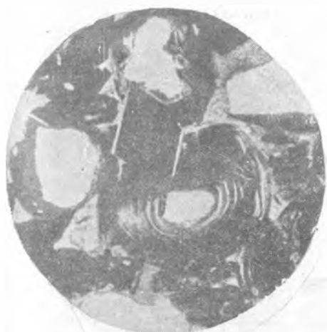
Фиг. 135. Тот же пласт. Замещение кристаллом магнетита концентрически слоистого оолита с кварцевым ядром (центр фото). \times 60 (по П. Вагнеру).
