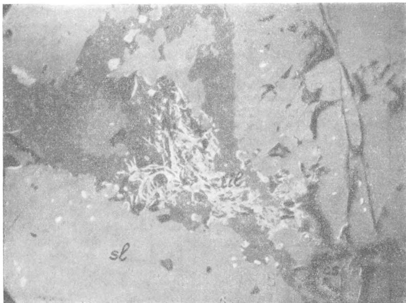
Фиг. 3. Сульфостаннат свинца типа тиллита или франкеита (*til*) в жилке нерудного минерала (темносерое) среди сфалерита (*sl*); темносерое внизу справа — касситерит (*cs*). Месторождение Сталинское, Приморье.
