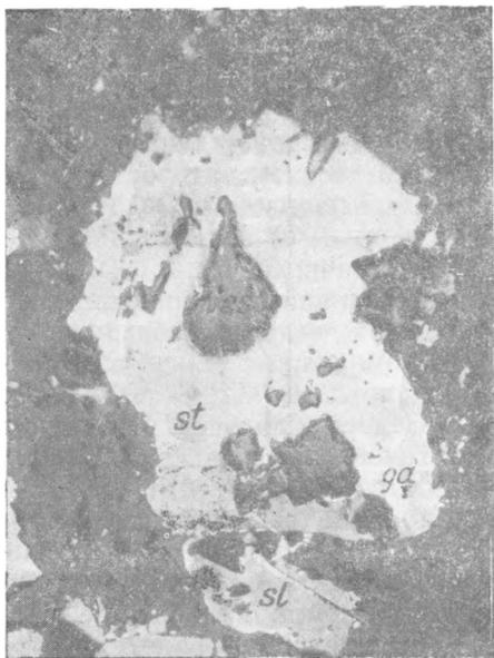
Фиг. 4. Реакционная каемка станнина вокруг включения касситеритов сульфидной руде; Сталинское месторождение, Приморье.  $\times 245$ .
