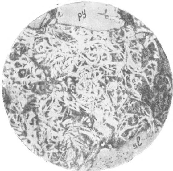
Фиг. 2. Тиллит — спутаннопластинчатый агрегат; светлосерое, сверху справа — пирит *py*, серое внизу — сфалерит *sl*.  $\times 300$ . Месторождение {Поопо. Боливия.
