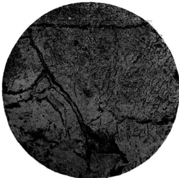
Фиг. 13. Реликтовая сетчатая структура змеевика в силифицированном змеевике. При одном никеле. Ув. 20 раз.
