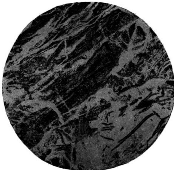
Фиг. 14. Распределение окислов железа вдоль первичных магнетитовых шнуров в силифицированном змеевике. При одном никеле. Ув. 20 раз.
