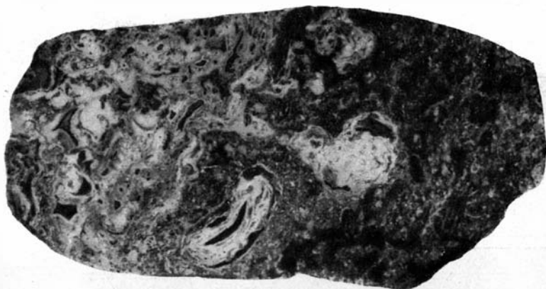
Фото 12. Переход биогермного мелкокомковатого литотамниевых известняка в органогенно-обломочный (тесовый) известняк с отдельными литотамниевыми шарами. Гора Закупная, верхний тортон; нат. вел.
