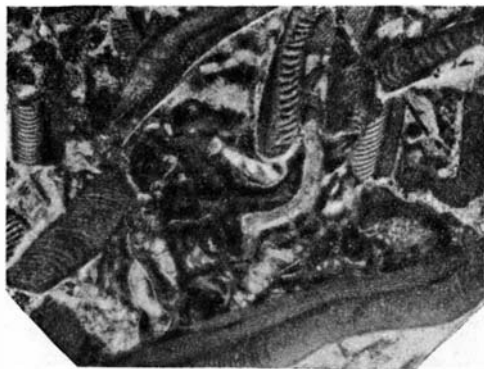
Фото 36. Литотамниевый крупнообломочный известняк из ветвистых разностей литотамний. Гора Тёс, верхний тортон, шлиф 22/46; увел. 46.
