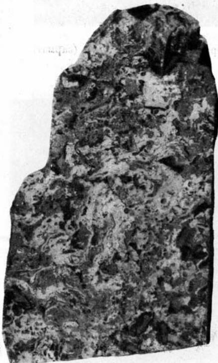
Фото 13. Биогермный полосчатый литотамниевый известняк. Среди литотамний большое количество мелких, неправильной формы участков афанитового известняка (темные пятна). Гора Закупная, верхний тортон; нат. вел.
