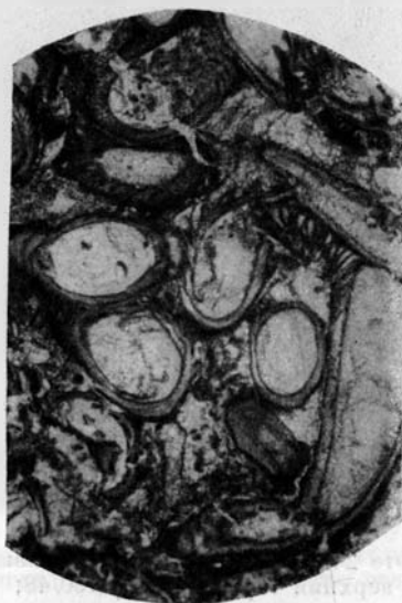
Фото 29. Серпуловый известняк. Хорошо видно сложное строение стенок серпул. Блещаниновка, нижний сармат, шлиф 390/48; увел. 10.
