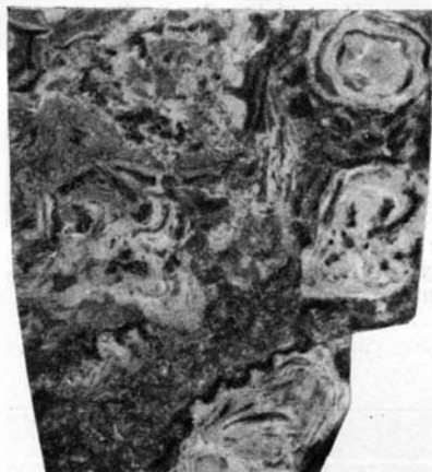
Фото 17. Известняк с литотамниевыми шарами. Гора Замок, верхний тортон; нат. вел.
