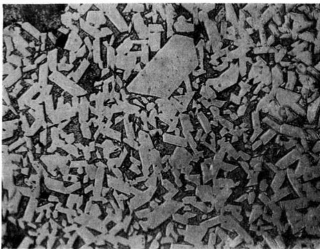
Фиг. 7. Микроструктура керамики на основе микрокорунга. Отраженный свет.  $\times 240$ .
