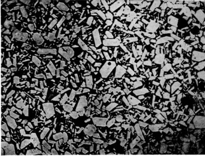
Фиг. 5. Микроструктура керамики на основе «технического глинозема». Отраженный свет.  $\times 240$ .
