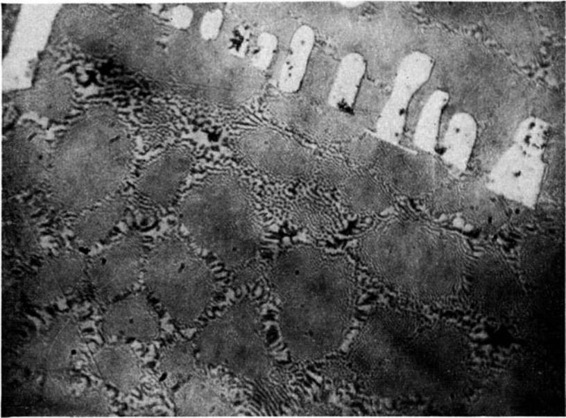
Фиг. 17. Сплав  $\text{FeS} + \text{FeO} + \text{Fe}$ , лежащий по составу на границе *I* и *II* полей диаграммы фиг. 15.  $\times 800$ .
