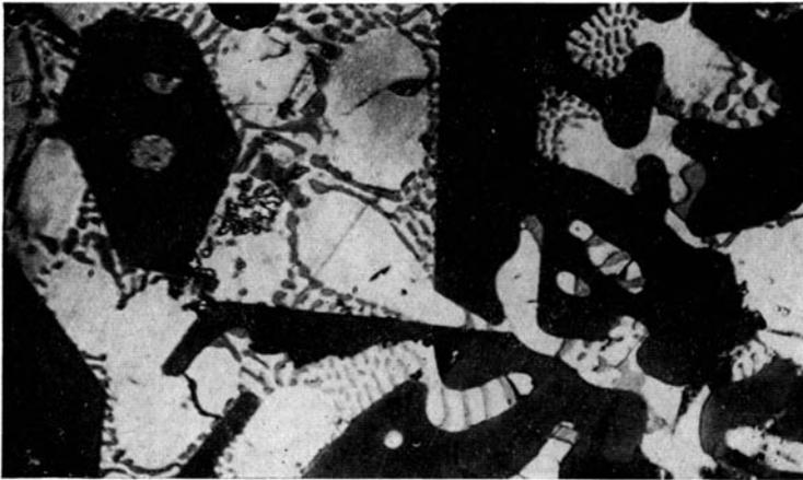
Фиг. 24. Сплав 42.8% FeO + 6.3% SiO<sub>2</sub> + 50.9% FeS (точка 5 диаграммы фиг. 20). × 590.
