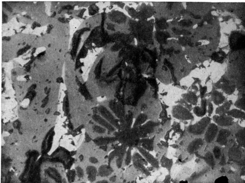
Фиг. 21. Сплав 58.1% FeO + 25.8% SiO<sub>2</sub> + 16.4% FeS (точка 1 диаграммы фиг. 20).  $\times 590$ .
