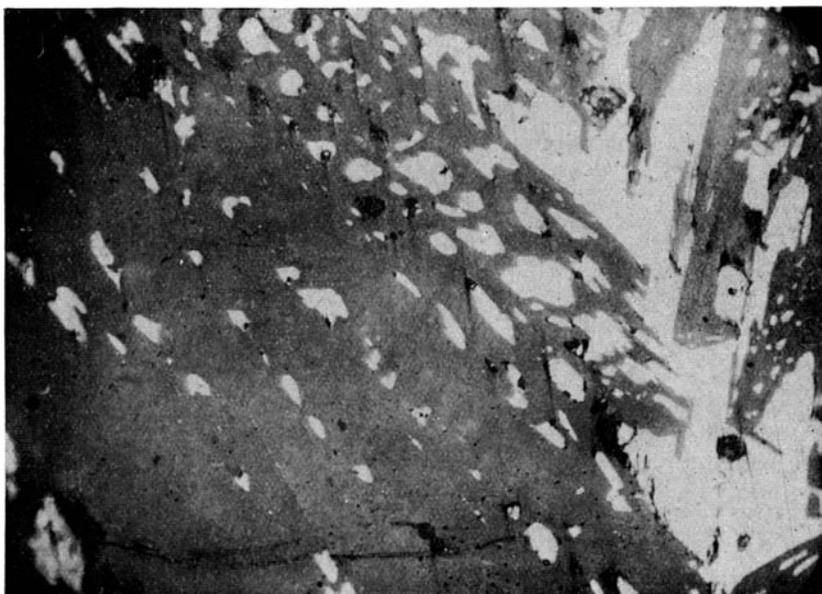
Фиг. 28. Сплав 60.4% FeO + 24.6% SiO<sub>2</sub> + 15% FeS (точка 11 диаграммы фиг. 20).  $\times 200$ .
