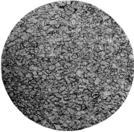
Фиг. 8. Кварцито-песчаник (Карелия), обр. № 622. С анализатором.  $\times 20$
