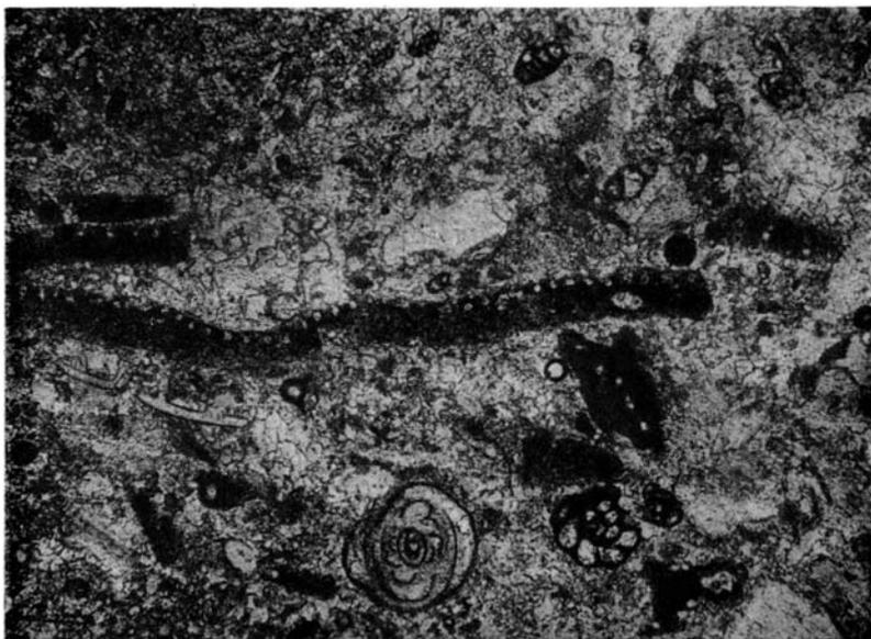
Фиг. 5. Частично перекристаллизованный фораминиферо-водорослевый известняк. Без анализатора,  $\times 50$
