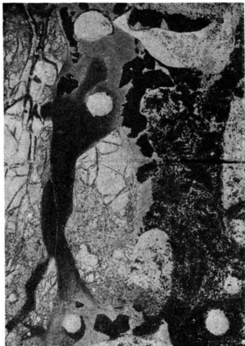
Фиг. 13. Контакт метакристаллизованного кварца (светлый) со стеклом, содержащим магнетит (черный). Без анализатора,  $\times 20$
