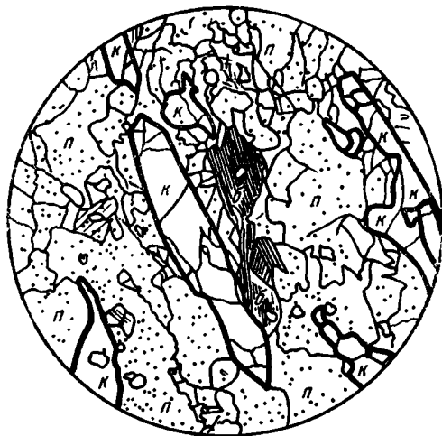
Фиг. 4. Гранито-гнейс из обнажений на западном крыле складки (фиг. 3, 43): к — кварц; п — полевой шпат; б — биотит
