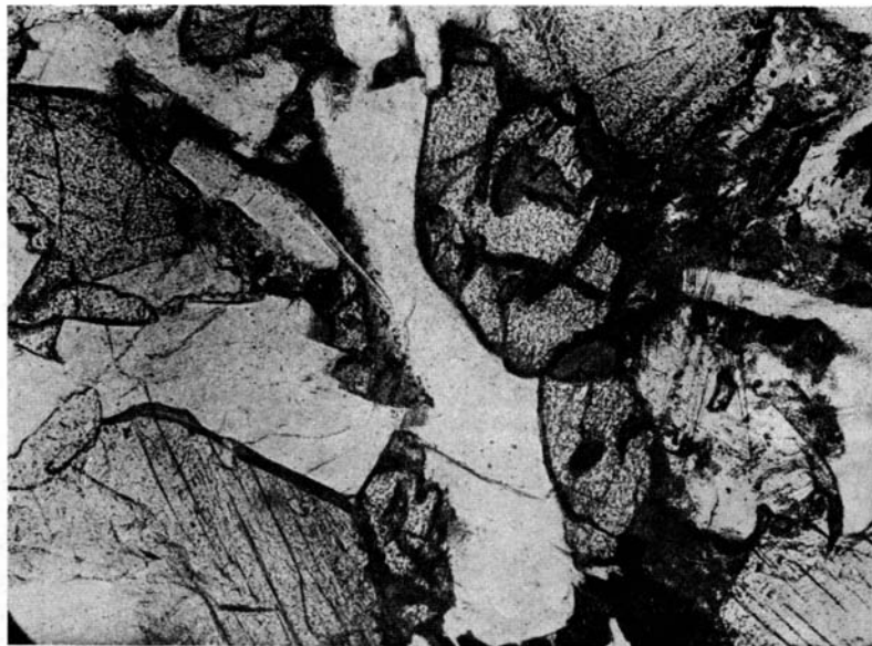
Фиг. 17. Коррозия плагиоклаза оливином, свидетельствующая о более позднем выделении последнего. Ув. 90; без анализатора
