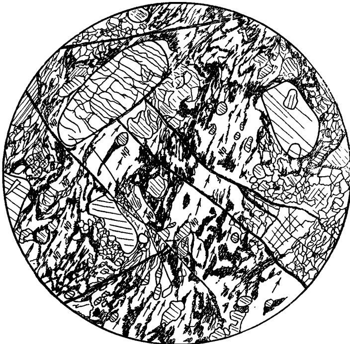
Фиг. 55. Структура гранито-гнейса из того же обнажения. Видны зерна полевых шпатов среди сильно ориентированной массы кварца, обладающего почти одновременным просветлением и агрегатным погасанием.
