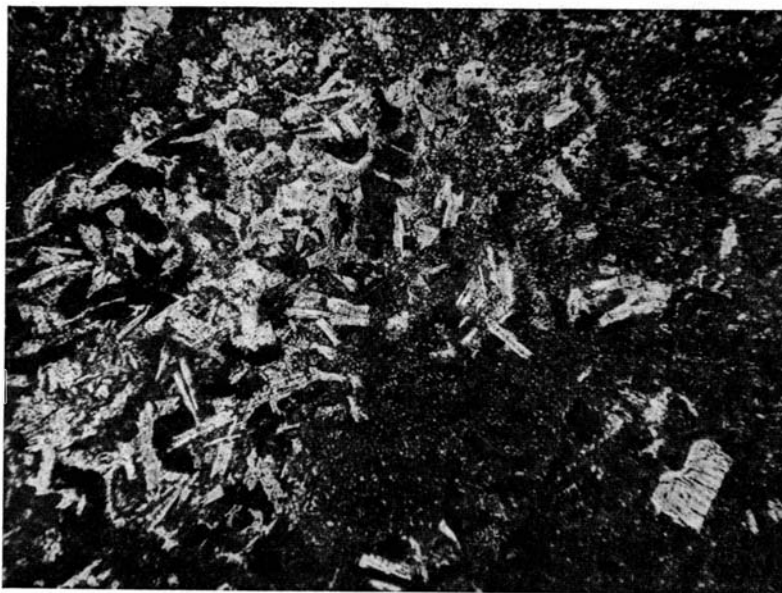
Фиг. 14. Участок диабаза офитовой структуры в диабазовом порфирите с роговиковой основной массой. Ув. 46; без анализатора
