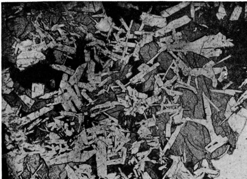
Фиг. 8. Пойкилофитовая структура оливинового диабаза. Ув. 76; без анализатора
