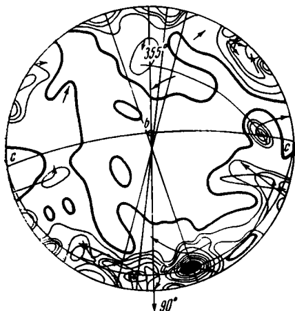
Фиг. 46. Диаграмма ориентировки оптических осей 140 зерен кварца из гранито-гнейса суженной части западного крыла складки.
