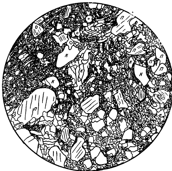
Фиг. 56. Микроструктура гранито-гнейсов, близкая к структуре милонитов к — кварц; п — полевой шпат. Мелкозернистая распыленная масса состоит из мельчайших частиц и обломочков тех же минералов
