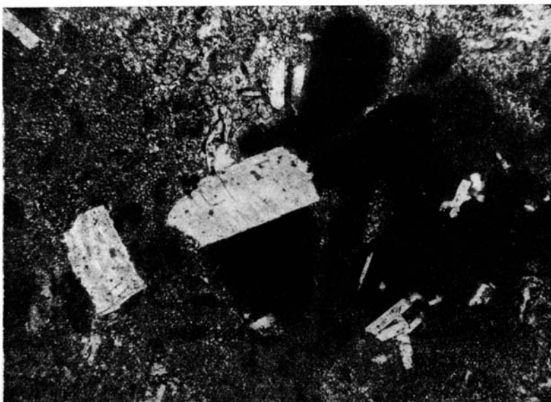
Фиг. 13. Неоднородное строение диабазового порфирита, обусловленное кучным распределением материала. Ув. 46; без анализатора
