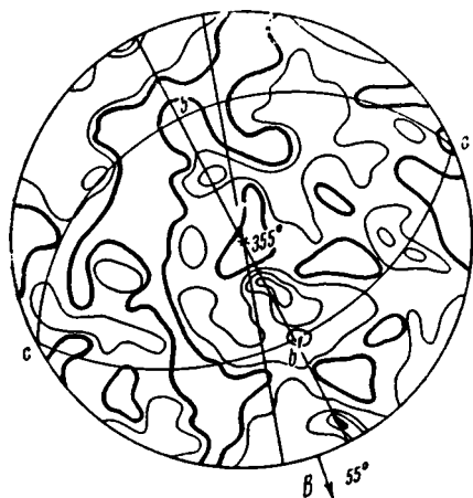
Фиг. 67. Диаграмма ориентировки оптических осей 127 зерен кальцита из мiasкита на западном склоне Собачьей горы.
