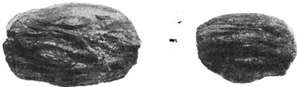
Фиг. 4. Ребристые конкреции барита из «коричневой» руды. Камыш-бурун, старый рудник ( \frac{3}{4} нат. вел.)
