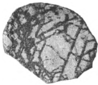
Фиг. 2. Петельчатая текстура. Прожилки пирита в массе сфалерита. Железо пирита проявлено K_4Fe(CN)_6
